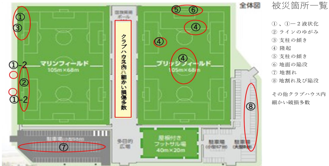
射水市フットボールセンター 令和6年能登半島地震 被災状況全体図
